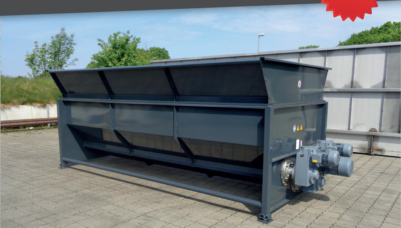
Der Pico vergrößert unser Angebot an Feststoffeinträgen. Bisher haben wir die Größen 30m<sup>3</sup>–120m<sup>3</sup> angeboten. Den Pico bieten wir in den Größen 12m<sup>3</sup>–16m<sup>3</sup> an. Damit hat er die optimale Größe für Biogasanlagen von 75 KW bis 150KW. Zusätzlich kann er mit jedem unserer Flüssigeintrags- und Schneckensysteme gekoppelt werden. Er wird aus Edelstahl gefertigt und unterliegt daher einem sehr geringen Verschleiß.
