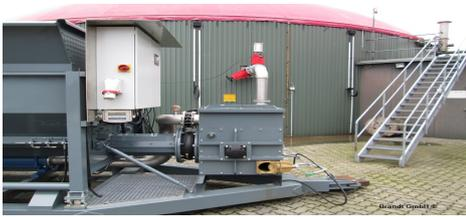
Die MaCBox wirkt überhöhten Energieverbräuchen im Fermenter entgegen und das bei einer Antriebsleistung von nur 7,5 KW.
